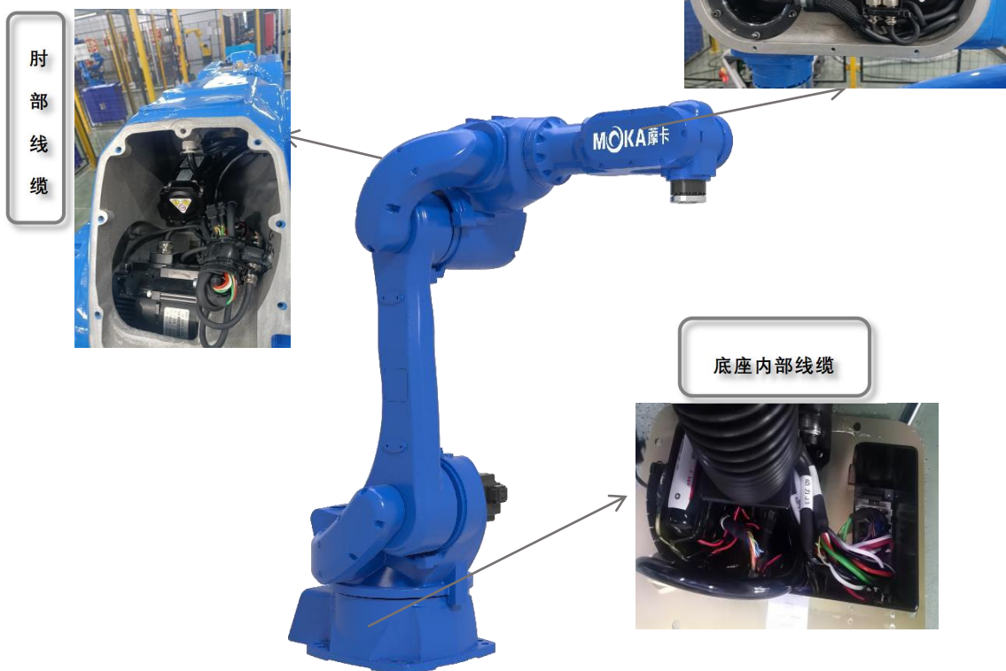
● MR30-1700 机器人线缆布局示意图
